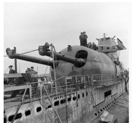
La tourelle du Surcouf équipée de 2 canons de 203 mm © passionair1940.fr
